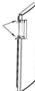
Étape 3 : couvrez les vis de la poignée en insérant les cache-vis dans les trous
